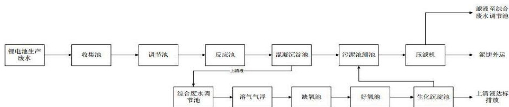
图 4-2 污水处理站废水处理流程图
